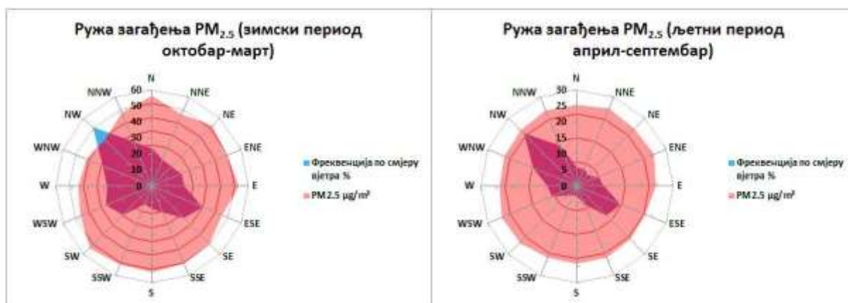
Графикон 29. Ружа загађења PM_{2.5} \mu g/m^3 Брод М.М. Рафинерија нафте Брод а.д. 2023. године
