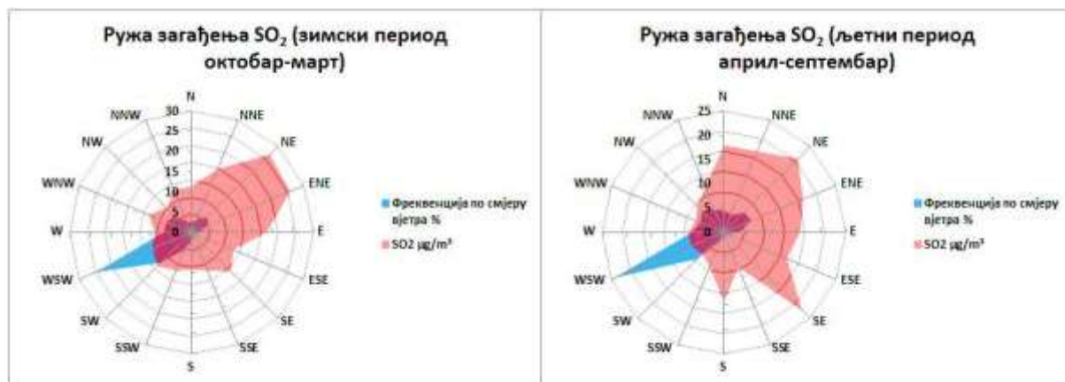
Графикон 9. Руже загађења SO 2 µg/m 3 Угљевик М.М. круг термоелектране 2023. године
