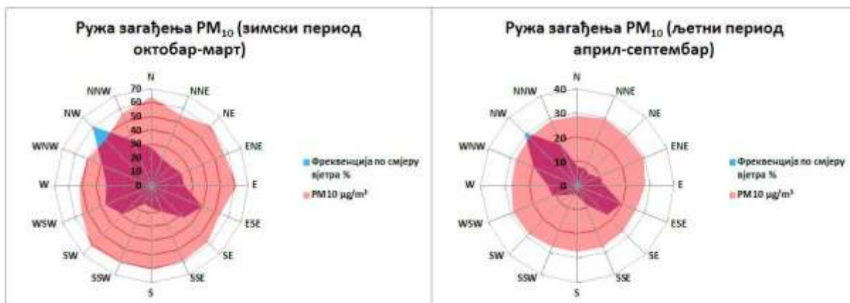
Графикон 21. Ружа загађења PM_{10} \mu g/m^3 Брод М.М. Рафинерија нафте Брод а.д. 2023. године
