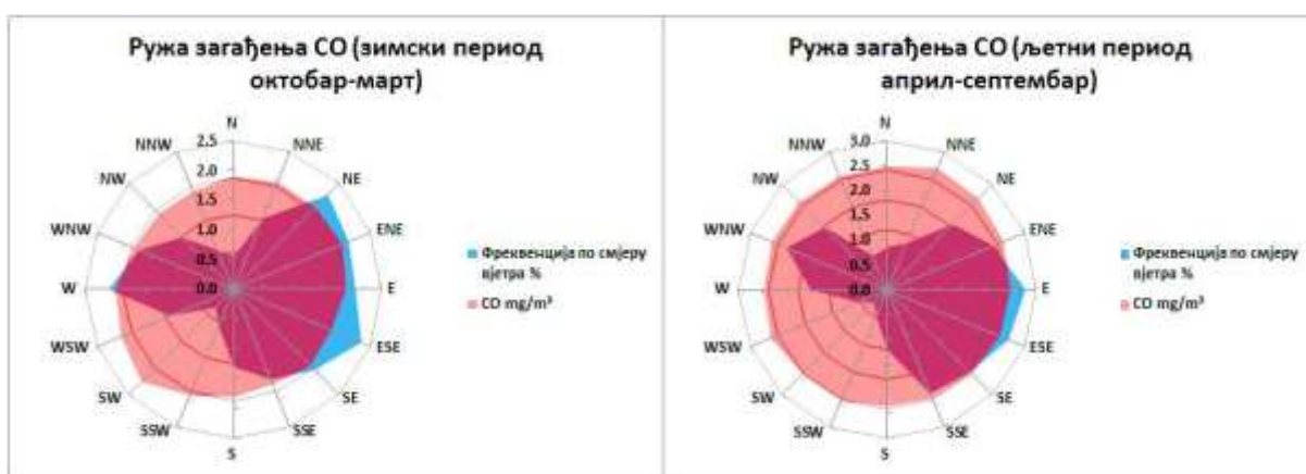
Графикон 35. Ружа загађења \text{CO mg}/\text{m}^3 Приједор М.М. круг мет. станице 2023. године
