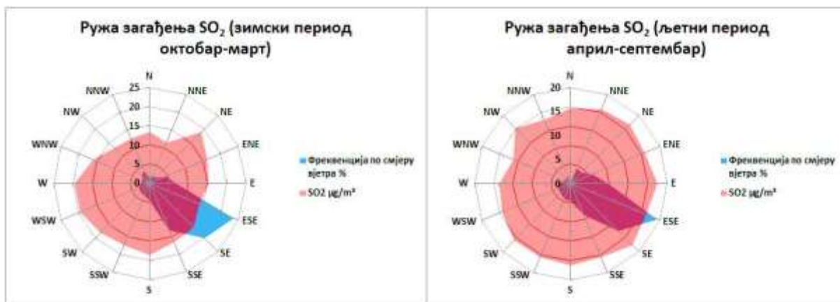
Графикон 7. Руже загађења \text{SO}_2 \mu\text{g}/\text{m}^3 Требиње М.М. круг мет. станице 2023. године
