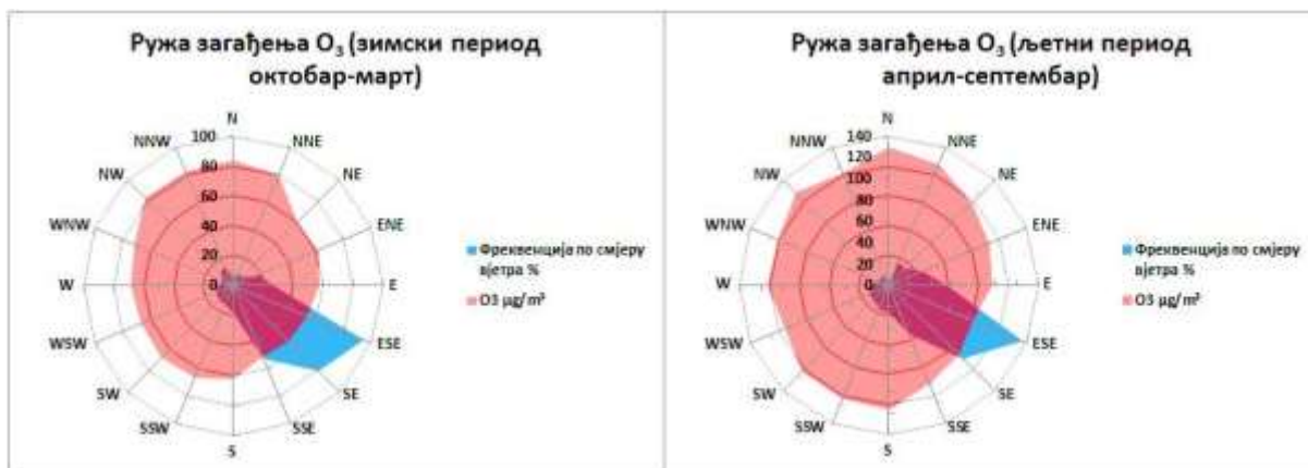
Графикон 46. Ружа загађења O_3 \mu g/m^3 Требиње М.М. круг мет. станице 2023. године
