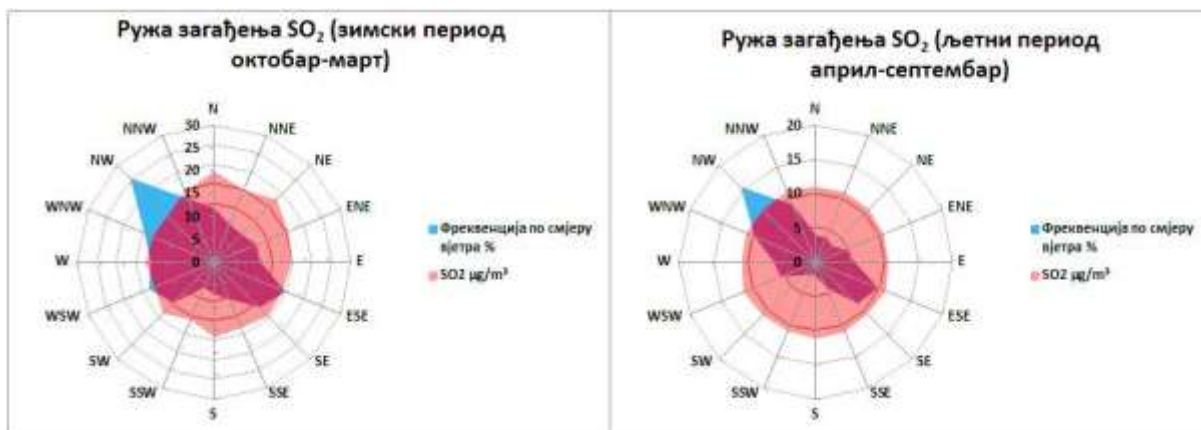
Графикон 3. Руже загађења \text{SO}_2 \mu\text{g}/\text{m}^3 Брод М.М. Рафинерија нафте Брод а.д. 2023. године
