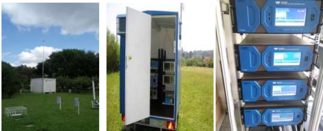
Слика 2. Мјерни инструменти за мониторинг квалитета ваздуха
